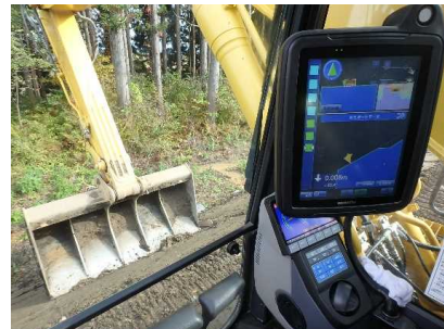
ICT建設機械による施工状況
